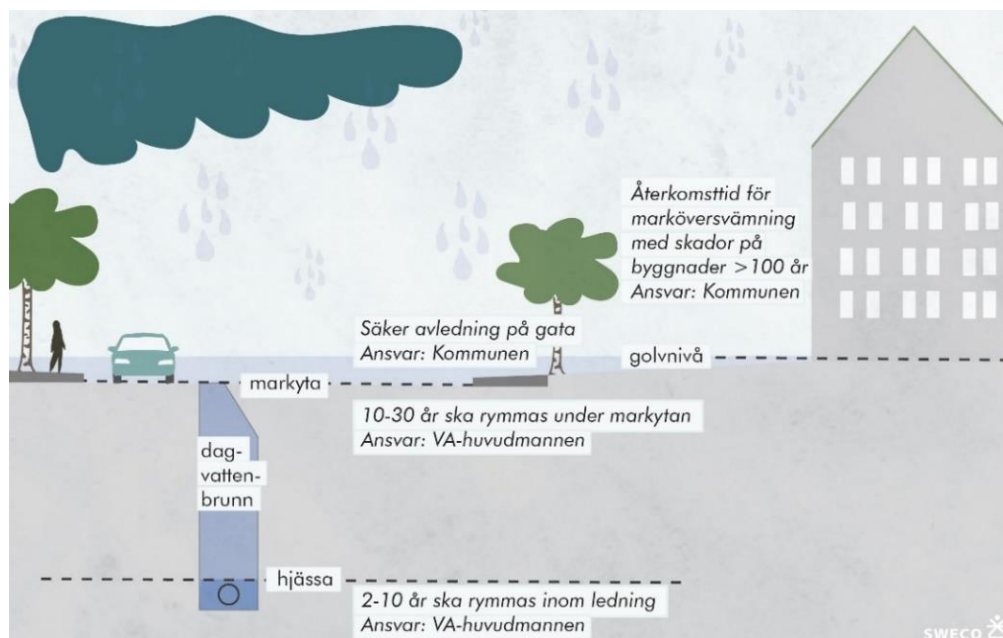
Figur 5 Illustration över dimensioneringskriterier, höjdsättning och ansvarsfördelning för hantering av dagvatten vid ny bebyggelse enligt rekommendation av Svenskt Vatten. De år som anges är den återkomsttid som avses.
