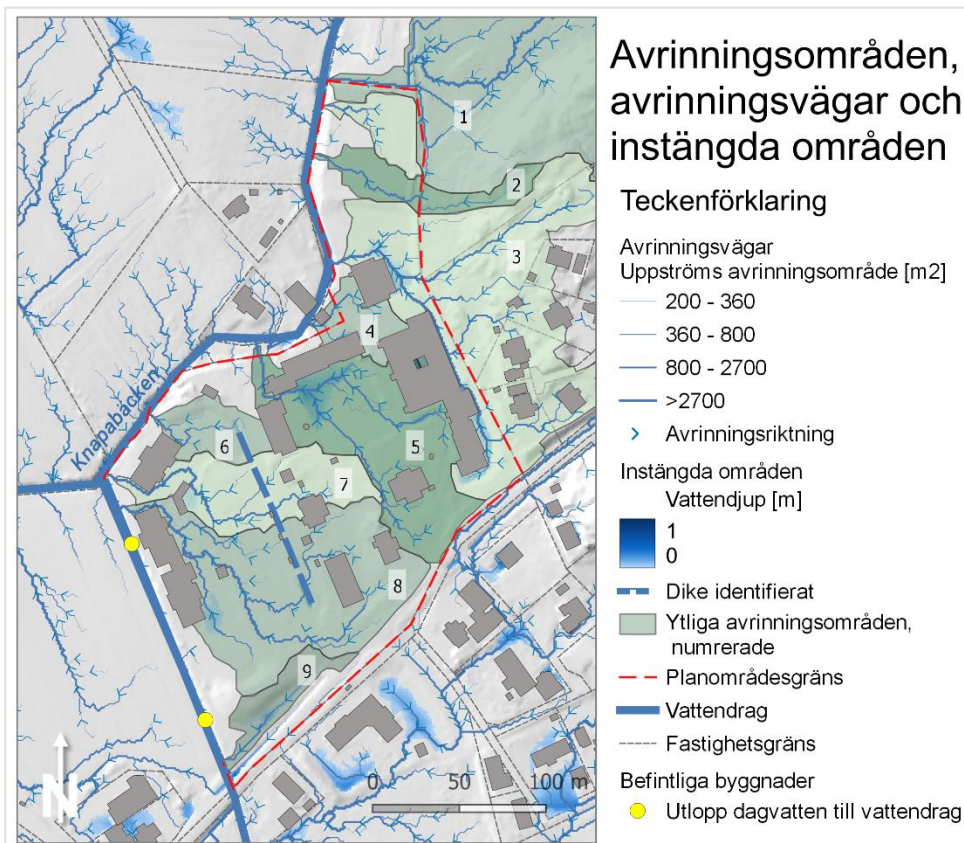
Figur 2. Modellerade avrinningsområden och rinnvägar, lågpunkter och instängda områden. Avrinningsområden är numrerade från 1-9.
